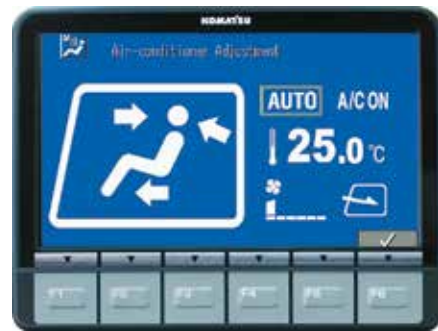
Кондиционер с автоматическим управлением
