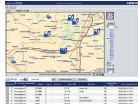
*Местоположение машин – Система мгновенно отображает положение ваших машин, в том числе тех, которые работают в других регионах.*
