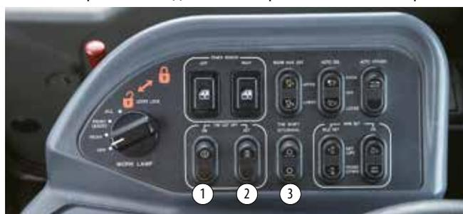
1: Выключатель коробки передач
