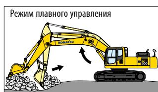
Стрела сохраняет плавающее положение и, перемещаясь вверх, уменьшает подъем передней части машины. Это ускоряет сбор взорванной скальной породы и зачистку поверхности.
