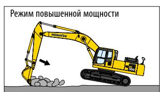
Увеличивается усилие опускания стрелы, что повышает эффективность рытья траншей треугольного и квадратного профиля в твердом грунте.
