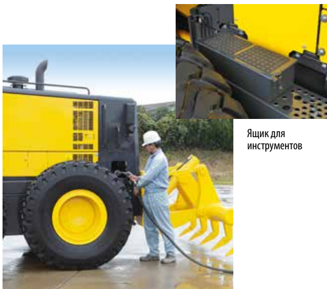
Дозаправка топливом доступна с уровня земли
