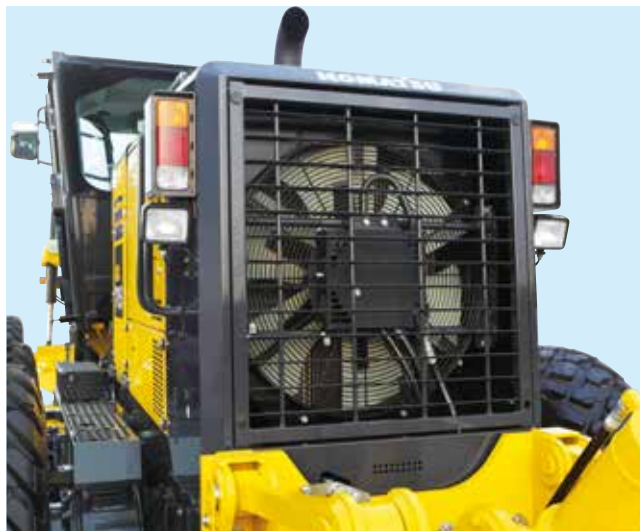
Работающий от гидропривода вентилятор радиатора
