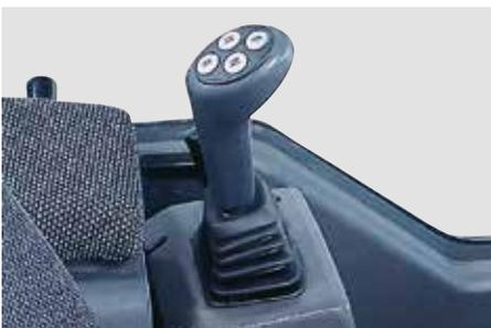
Рычаг предназначен для включения автоматической трансмиссии
