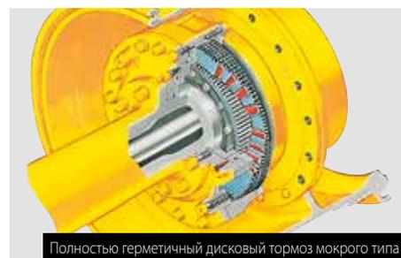
Полностью герметичный дисковый тормоз мокрого типа
