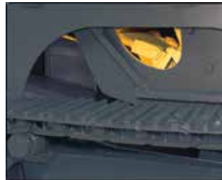
Отверстие со стороны дробилки (с обеих сторон ходовой части)
