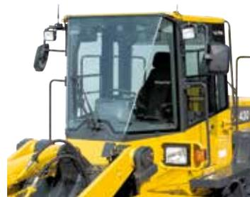
Широкое плоское ветровое стекло, не имеющее перегородки, обеспечивает хорошую обзорность. Рычаг стеклоочистителя охватывает большую площадь, обеспечивая широкий обзор даже
