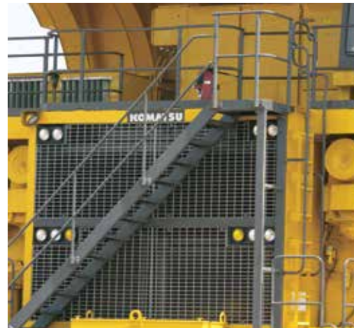
Вход на лестницу доступа в кабину самосвала Komatsu 960E-2K может быть предусмотрен как с правой, так и с левой стороны, что определяется выбором заказчика.
