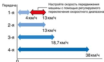
Регулируемый переключатель скоростного диапазона позволяет оператору настраивать скорость передвижения машины при выполнении работ по V-образной схеме в условиях ограниченного пространства. На 1-й передаче оператор может отрегулировать скорость передвижения с помощью регулируемого переключателя скоростного диапазона, обеспечивая соответствие скорости и работы гидравлической системы пройденному расстоянию.
