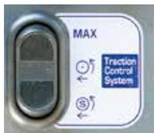
Кроме того, при переводе включателя противобуксовочной системы в положение ВКЛ, максимальное тяговое усилие может регулироваться в пределах трех уровней (на обычных погрузчиках предусмотрен один уровень). Это позволяет оператору выбирать оптимальное тяговое усилие с учетом дорожных условий.
