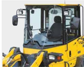
в дождливую погоду. Большая по площади кабина обеспечивает оператору максимальное пространство для работы. За счет смонтированного спереди кондиционера увеличился угол наклона сиденья и появилась возможность регулировки его смещения назад.
