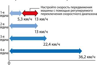
Регулируемый переключатель скоростного диапазона позволяет оператору настраивать скорость передвижения машины при выполнении работ по V-образной схеме в условиях ограниченного пространства. На 1-й передаче оператор может отрегулировать скорость передвижения с помощью регулируемого переключателя скоростного диапазона, обеспечивая соответствие скорости и работы гидравлической системы пройденному расстоянию.
