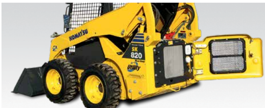
Задняя дверь: удобная проверка и очистка радиаторов
