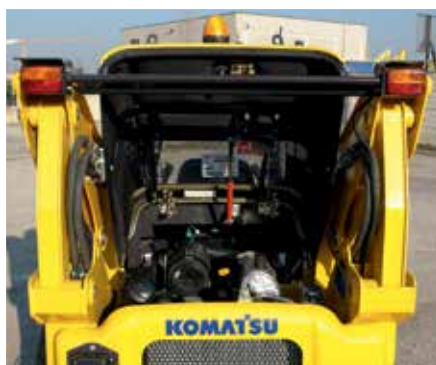
Капот: быстрая проверка двигателя
