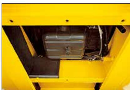
**Топливный бак большой емкости с антикоррозионным покрытием**
