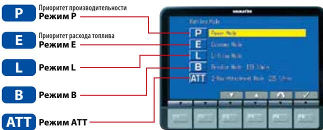
Экономичный режим предусматривает 4-ступенчатую регулировку. Выбирается из меню настройки экономичного режима для снижения выходной мощности при переходе со ступени E0 на ступень E3, улучшая при этом показатели по расходу топлива.
