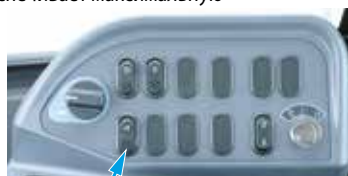
Переключатель двух режимов мощности двигателя
