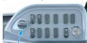
Переключатель выбора режима переключения передач
