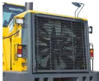
радиатора для его очистки в обратном направлении, нажав соответствующий переключатель на панели управления в кабине.
