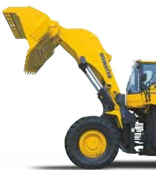
Погрузчики серии WA600 со стандартной стрелой рассчитаны на загрузку самосвалов грузоподъемностью 60 тонн (70 коротких тонн). На модели WA600-3 требуется установка стрелы с большим подъемом и ковша вместимостью 6,4 м<sup>3</sup>. Благодаря увеличенной высоте кабины модели WA600-6 оператор имеет отличный обзор при выполнении погрузочных работ.
