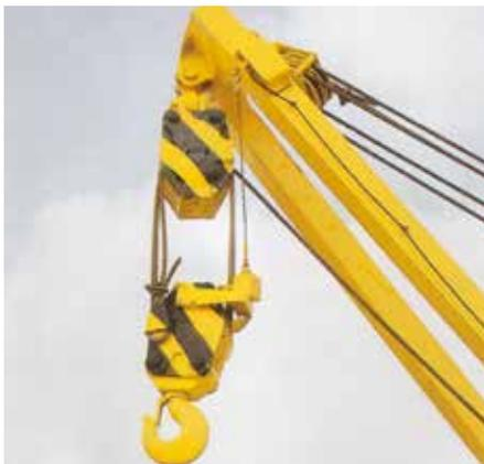
**Автоматический ограничитель высоты подъема груза:** Предупреждает оператора о превышении предельной высоты подъема крюка, что при обрыве каната препятствует повреждению важных компонентов машины.
