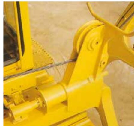
**Автоматический ограничитель максимального угла подъема стрелы:** Когда стрела доходит до предварительно установленного положения, рычаг управления стрелой автоматически возвращается в нейтральное положение. Это упрощает работу и повышает производительность.
