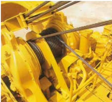
**Трансмиссия лебедки:** Компактная и легкая лебедка имеет мокрое многодисковое сцепление и трансмиссию. Трансмиссия имеет две независимых силовых передачи, позволяющие одновременно управлять крюком и стрелой, что обеспечивает более безопасную и производительную работу трубоукладчика.
