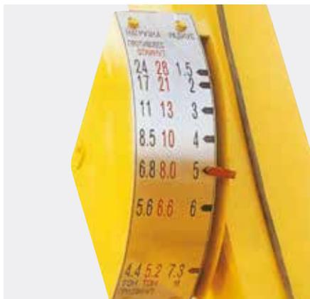
**Индикатор грузоподъемности и вылета:** Для обеспечения безопасности работ по укладке труб наглядно показывает в соответствии с углом подъема стрелы идеальный вылет и номинальные подъемные нагрузки.
